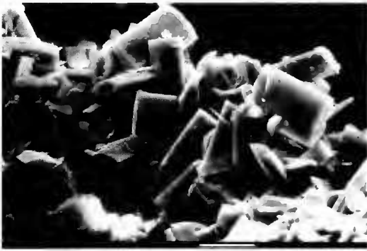
FIG. 5. — Assemblage de cristaux prismatiques de manganite, constituant des plaquettes noires indurées dans les niveaux manganésifères de la carotte MD 81403 (Atlantis II, bassin est). Échelle : 10 µm.
